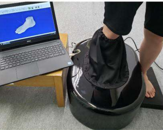
3D scannerにより足部形態を測定
